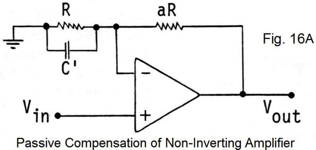
$$V_- = \frac{V_{out}}{(1+a) + a s C' R} \quad (21a)$$
